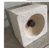
写真上:中央に黒く丸く見えるものが今回のワーク(丸棒)です 写真左:ラジアントカップバーナ
