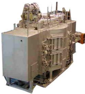
高速熱風炉 (T5/T6 熱処理炉)
