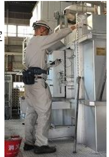
燃焼排ガス測定中
