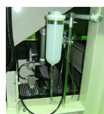
↑コンベアチェーンに滴下式自動給油
