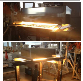
近赤外線ヒーターによる照射
