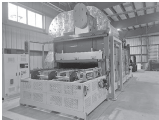
写真1 製作中の加熱設備。1台ずつ手作業で組み立てる
