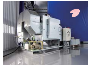
時短改造後 短時間で全体が昇温し、温度分布が均一となる
